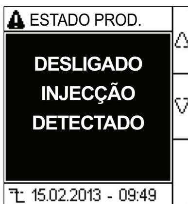
Por padrão, o parâmetro de detecção de injeção desligada é ativado (parâmetro **Injec. deslig.** definido como **LIGADO**).
