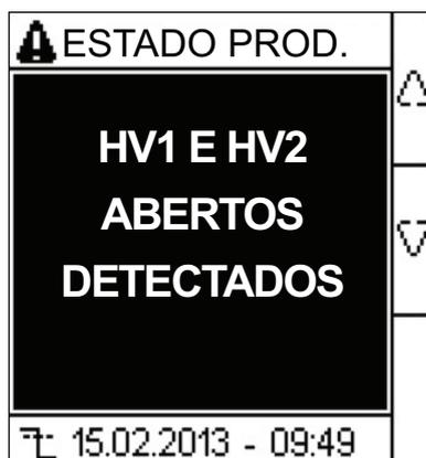
Quando os terminais HV1 e HV2 não são reduzidos e o parâmetro **Adapt. V** é definido como **Nenhum**, o dispositivo exibe a resistência do sistema não aterrado.
