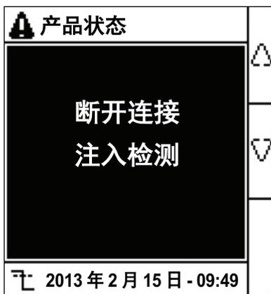
如果将**断开注入连接**参数设置为**关**，则设备将显示  $R > 10\text{ M}\Omega$ 。
