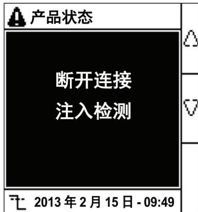
默认情况下，已激活检测断开的注入连接参数（参数**断开注入连接**设置为**开**）。
