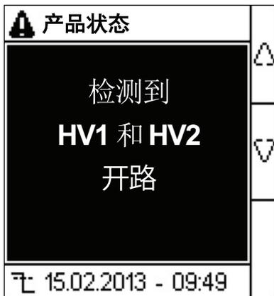
当端子 HV1 和 HV2 未短接且**电压适配器**参数设置为**无**时，设备将显示未接地系统的电阻。
