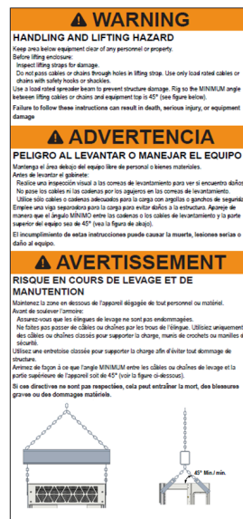
Figure 2 - Étiquette de directives de manutention – Tableaux de distribution avec sangles de levage
