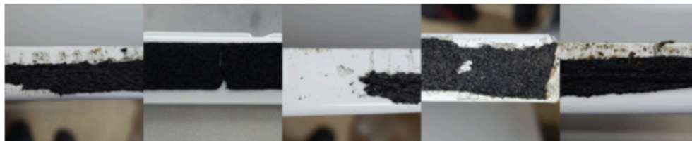
Figure 10 - Exemples de joints d'étanchéité endommagés
