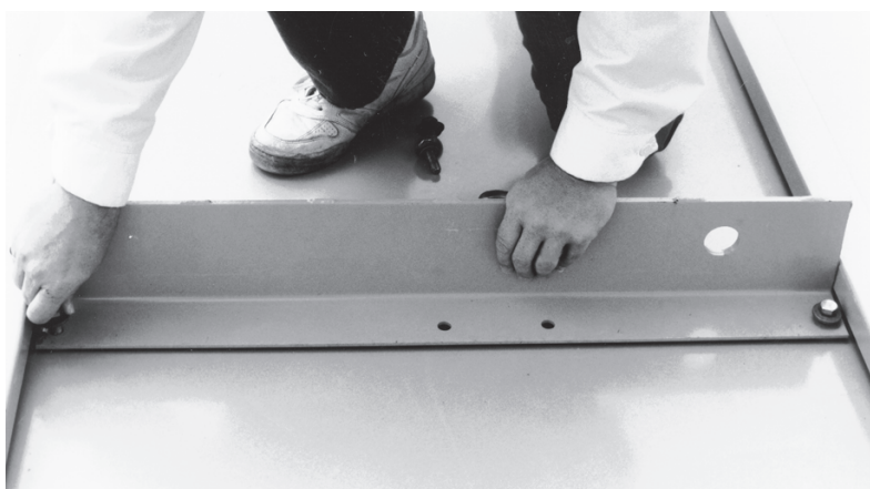
Figure 10 - Retrait des petites pattes de levage
