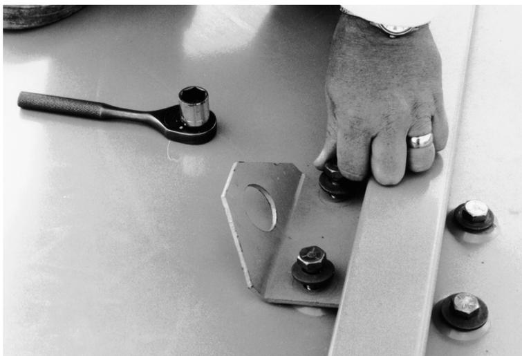
**Figure 24 - Obturation des trous avec les boulons et rondelles d'étanchéité**
