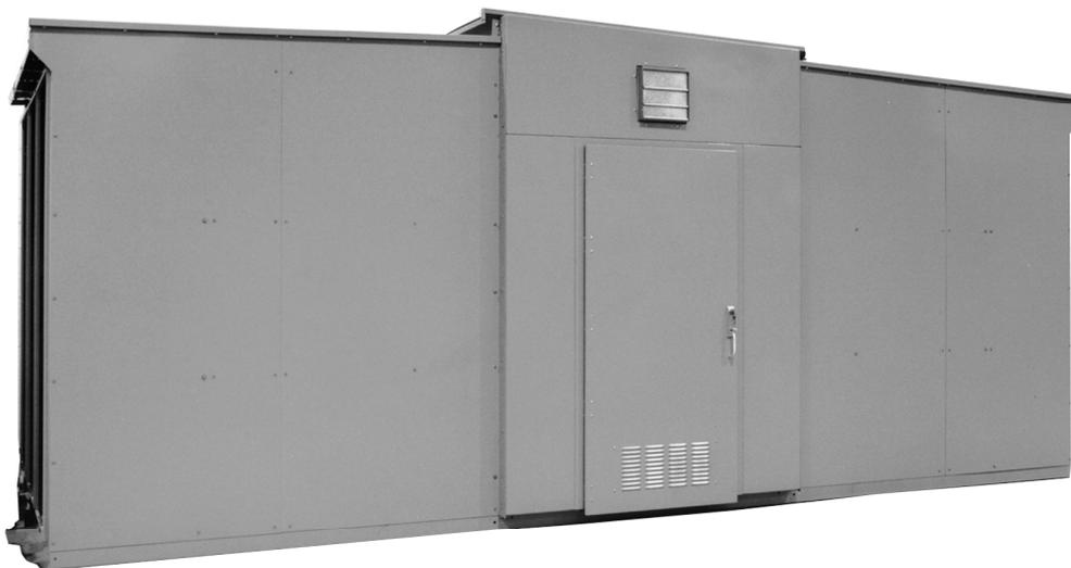
L'appareillage avec allée commune est expédié avec les sections d'appareillage de commutation « côté bas » et « côté élevé » entièrement assemblées et prêtes à installer sur une dalle en béton. L'allée est expédiée en modules.
