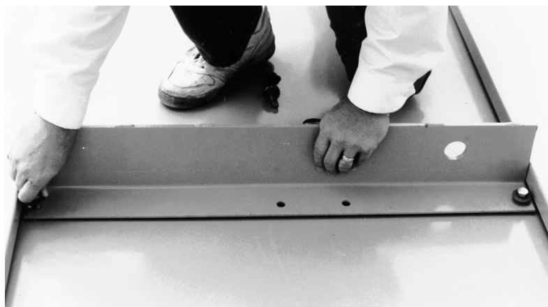
Figure 23 - Retrait des petites pattes de levage
