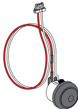
Le bouton-poussoir de fermeture électrique (BPFE) effectue la fermeture électrique du disjoncteur. Il prend en compte les conditions internes de fermeture de l'appareil et les conditions externes qui font partie du système de contrôle et de surveillance de l'installation. Il se connecte à la bobine de fermeture standard (XF) ou à la bobine de fermeture communicante (XF diag&com).
