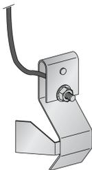
Le kit de mise à la terre (KMT) permet la mise à la terre du mécanisme du disjoncteur lorsque le capot est retiré. La mise à la terre est effectuée via le châssis pour la version débrochable et via la plaque latérale de montage pour la version fixe.
