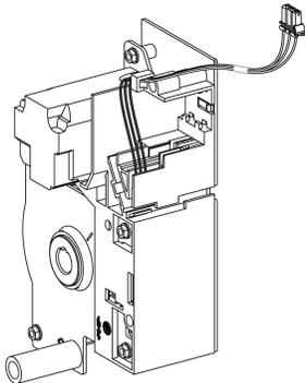
Le moteur de réarmement du ressort (MCH) arme automatiquement le ressort d'accumulation d'énergie lorsque le disjoncteur est fermé, permettant la fermeture instantanée du disjoncteur après ouverture.
