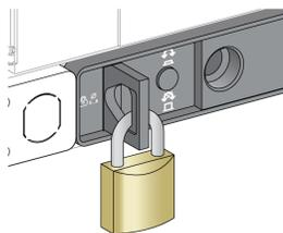
Le châssis peut être verrouillé en position Débroché. Dans ce cas, la manivelle d'embrochage ne peut pas être insérée.
