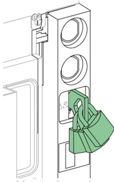
El zócalo se puede bloquear en la posición desconectada. Cuando el zócalo está bloqueado en posición desconectada, no se puede insertar la manivela.
