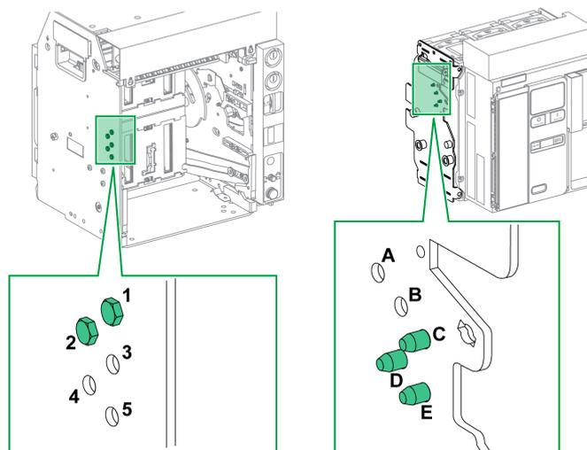
La combinación de pines seleccionada en el chasis debe corresponder con la seleccionada en el aparato (consulte la tabla siguiente). Por ejemplo, la combinación 12 en el chasis se corresponde con la combinación CDE en el aparato.
