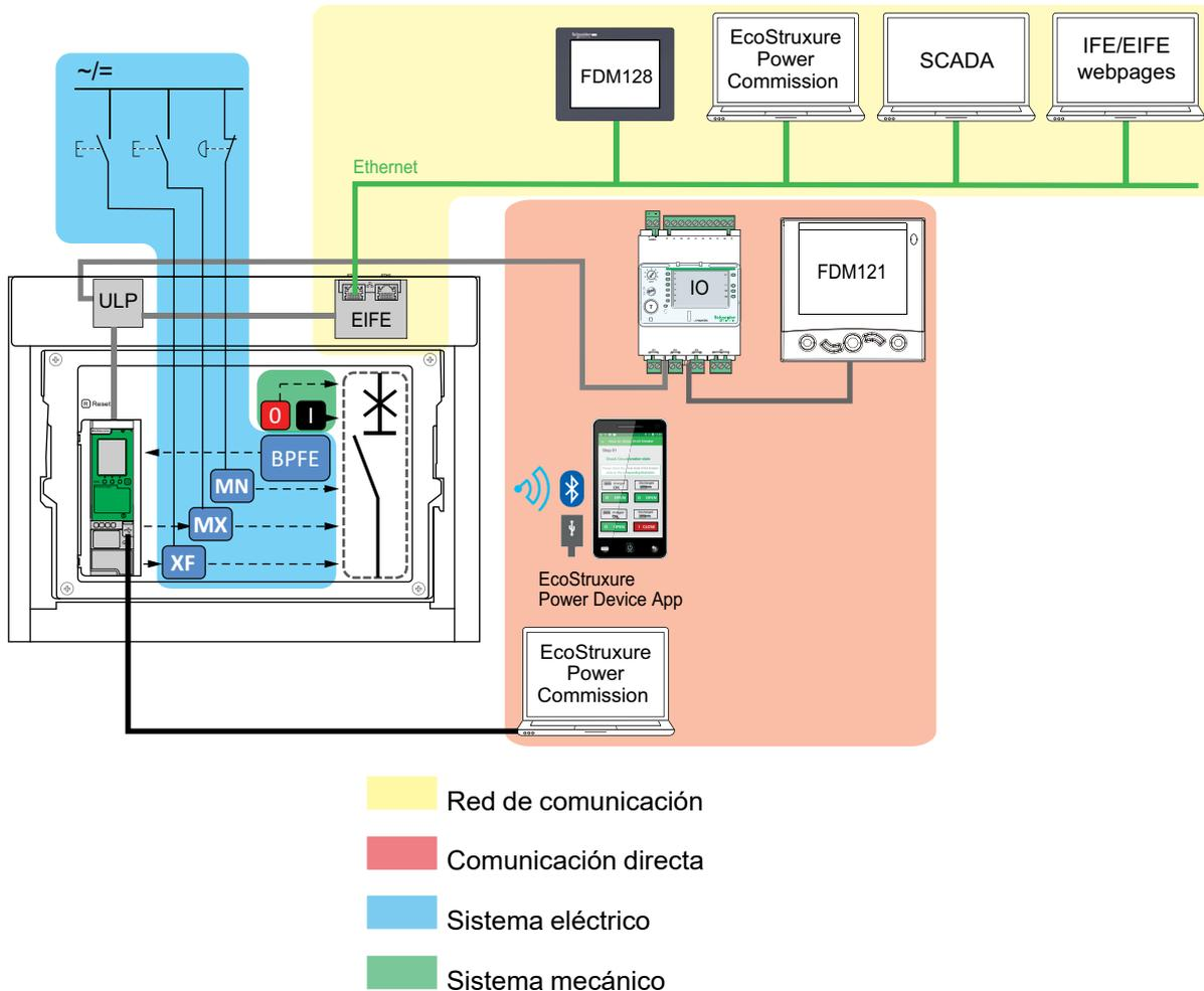
Si las acciones de solución de problemas de una capa no dan resultado, vaya a la capa siguiente, y así hasta llegar a la capa mecánica. Si no se puede resolver el problema tras solucionar los problemas de la capa mecánica, póngase en contacto con su Representante de servicios Schneider Electric.
