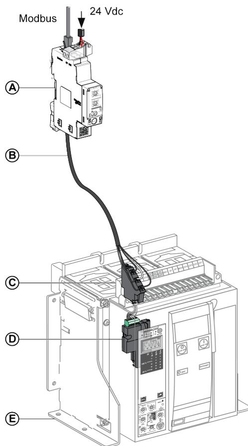
**A** Interface Modbus-SL IFM pour un disjoncteur
