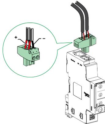
Il est conseillé d'utiliser une alimentation homologuée UL/approuvée UL à tension/intensité limitée ou de Classe 2 avec 24 V CC, 3 A maximum.
