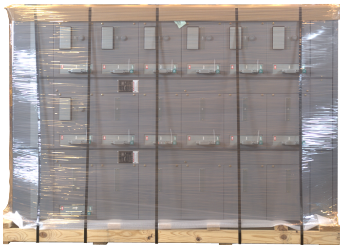
Figure 2 - Centre de commande de moteurs emballé en position allongée sur le côté (typique pour la plupart des sections)
