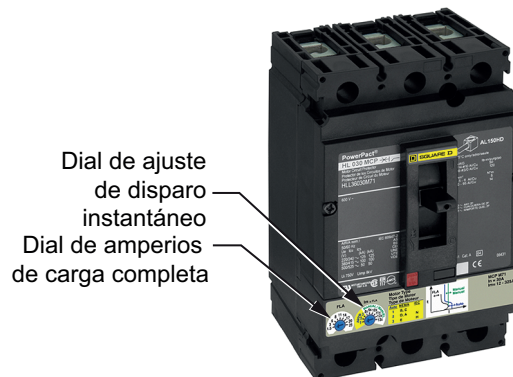
Figura 128 - Selector de ajuste del disparo magnético PowerPacT de marco H y marco J
