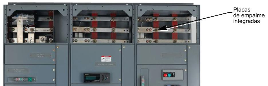
3. Localice las placas de empalme integral. Generalmente, las placas de empalme se encuentran en el extremo izquierdo de la barra principal del CCM en cada sección de transporte. En algunas construcciones, el ensamble de empalme puede estar incluido como kit, en una caja asegurada dentro de la estructura del CCM.
