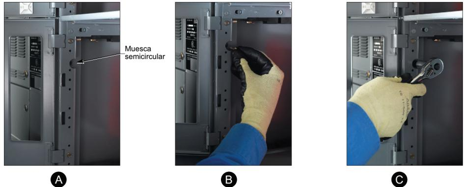
4. Utilice cuatro de los tornillos autorroscantes de cabeza hexagonal de 3/4 x 1/4-20 incluidos con el kit de tornillería, para unir los canales verticales frontales de las esquinas, insertando los tornillos por los orificios de paso situados en las muescas en forma de semicírculo y en el orificio autorroscante correspondiente (consulte Unión de los canales de esquina, página 23, Vista B).
