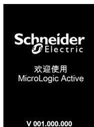
启动屏幕在 MicroLogic Active 控制单元每次通电时显示。显示此屏幕期间，控制单元上的所有按钮均不起作用。此屏幕持续显示的时间为控制单元启动时间。此持续时间结束时，将显示 LSIG 主屏幕 或任何活动的弹出式屏幕。
