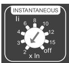
瞬时保护吸合电流  $I_i$  藉由 MicroLogic B 脱扣单元正面的  $I_i$  多位旋钮来设置。
