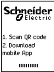
La pantalla de arranque se muestra cada vez que se enciende la unidad de control MicroLogic X. Ninguno de los botones de la unidad de control funcionará mientras aparezca esta pantalla. La pantalla se muestra durante el arranque de la unidad de control. Al finalizar este periodo, se mostrará la pantalla **Inicio** o cualquier pantalla emergente activa.
