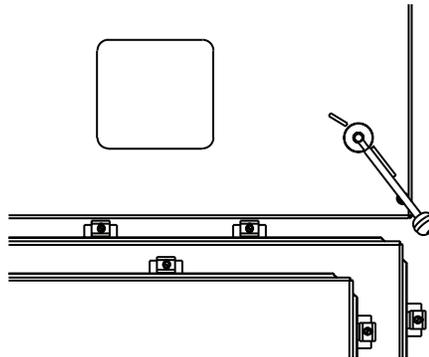
2. Sujete la palanca del operador del interruptor desconectador y gire la palanca en sentido horario hacia arriba hasta la posición On/Closed (se muestra en Palanca del interruptor en la posición On/Closed, página 49).
