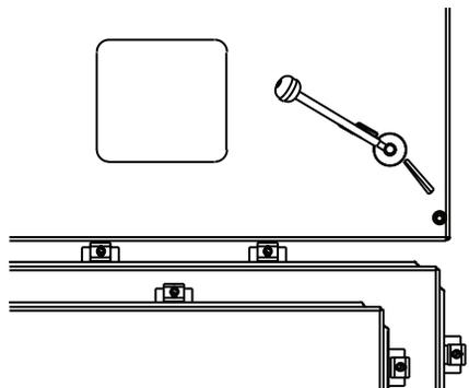
3. Utilice la ventana de visualización para ver el interruptor desconectador y verificar que las aspas para las tres fases estén en la posición On/Closed (se muestra en Cambie las aspas a la posición Closed, página 50).
