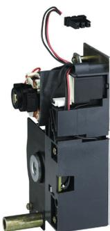
Le motoréducteur MCH réarme automatiquement les ressorts d'accumulation d'énergie des mécanismes dès la fermeture du disjoncteur.
