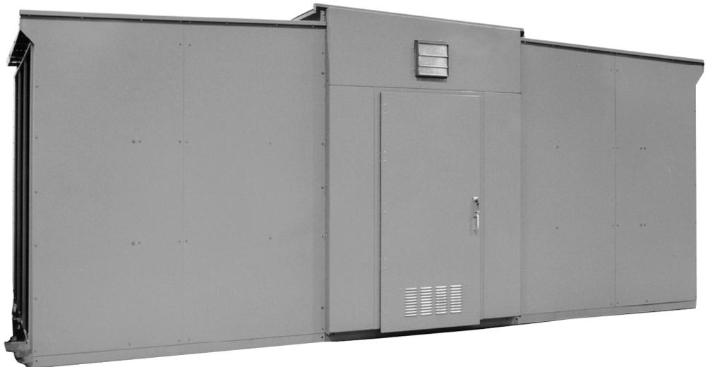
El tablero de fuerza con pasillo de servicio común se envía con las secciones del "lado bajo" y del "lado alto" completamente ensambladas y listas para ser colocadas en una plataforma de hormigón. El pasillo se envía en subensambles.
