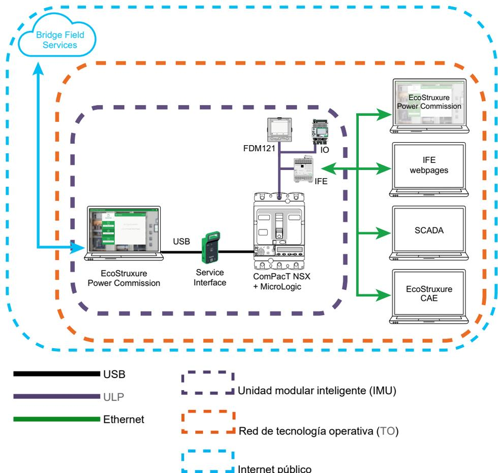
La unidad funcional modular inteligente (IMU) representa el interruptor automático ComPacTNSX o PowerPacT de marcos P y R, la unidad de disparo MicroLogic y los módulos ULP asociados, la interfaz de comunicación y los módulos IO.
