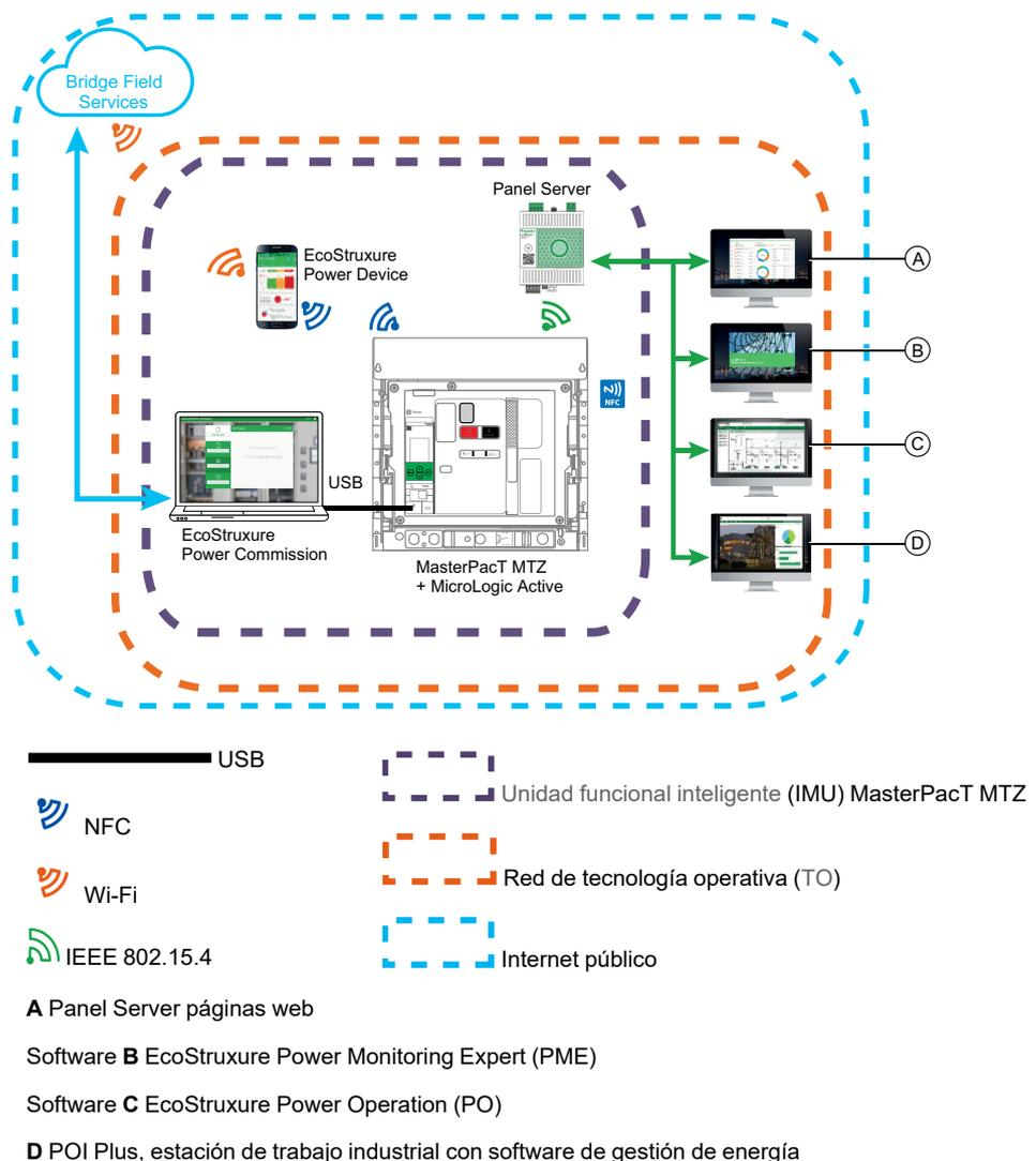
La unidad funcional modular inteligente (IMU) de MasterPacT MTZ representa el interruptor automático, la unidad de control MicroLogic Active y la interfaz de comunicación.
