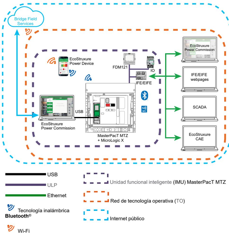
La unidad funcional modular inteligente (IMU) de MasterPacT MTZ representa el interruptor automático, la unidad de control MicroLogic X y los módulos ULP asociados, la interfaz de comunicación y los módulos IO.
