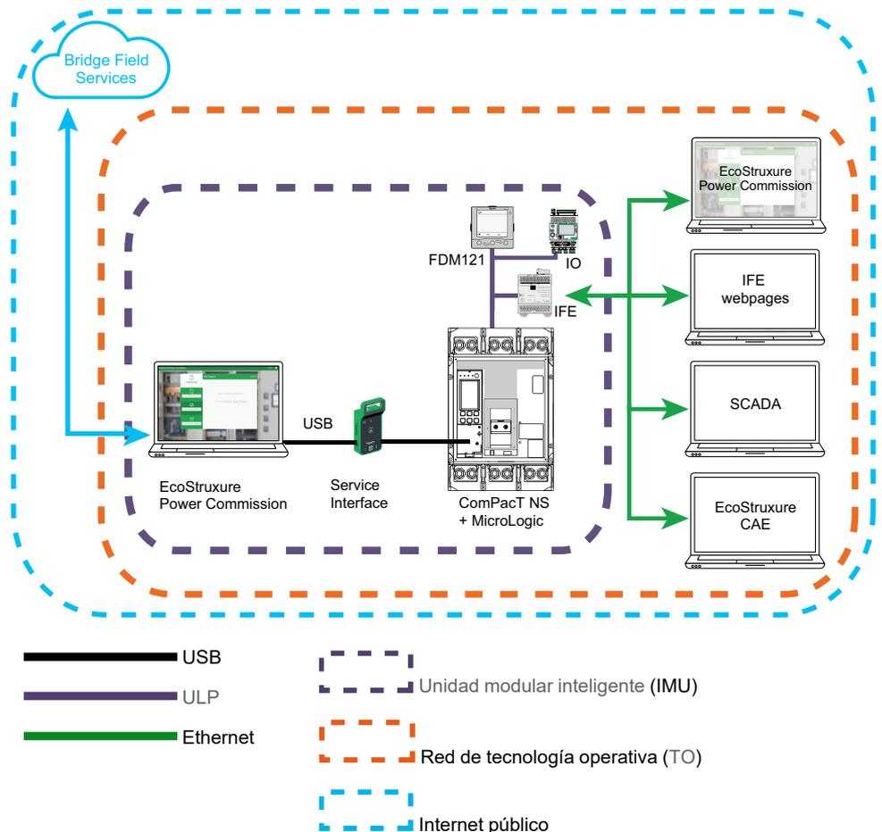
La unidad funcional modular inteligente (IMU) representa el interruptor automático MasterPacT NT/NW, ComPacT NS y PowerPacT de marcos P y R, la unidad de disparo MicroLogic y los módulos ULP asociados, la interfaz de comunicación y los módulos IO.
