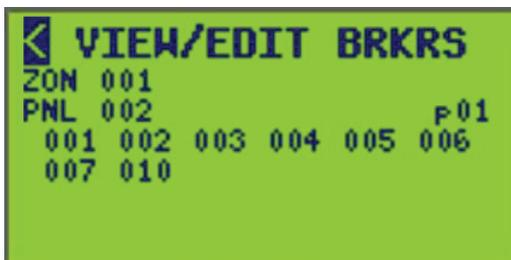
La ligne ZON affiche le numéro de la zone sélectionnée et l'étiquette de nom comprise entre 1 et 256 (affichée sous la forme ZON 001), et la ligne « Panel » affiche le numéro du panneau sélectionné et l'étiquette de nom comprise entre 0 et 7 (affichée sous la forme PNL 002). Les disjoncteurs disponibles sur le panneau sélectionné sont indiqués sous ZON et PNL (maximum de 24 disjoncteurs par page. Voir Visualisation des pages de disjoncteur).
