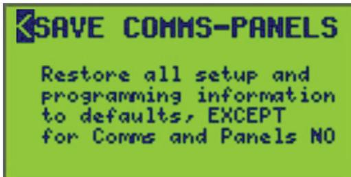
2. Sélectionnez YES pour restaurer partiellement les réglages d'usine par défaut du contrôleur (sauf la configuration des communications et des panneaux).
