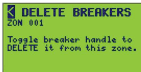
Le contrôleur est mis en mode LEARN lors de l'accès à un de ces écrans. Tout disjoncteur qui change d'état alors qu'il est sur l'écran ADD BREAKERS ou DELETE BREAKERS est ajouté (ADDED) ou supprimé (DELETED) du mappage des disjoncteurs de la zone.
