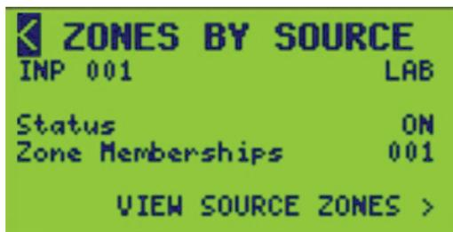
L'étiquette de nom, l'état et la valeur d'appartenance à la zone de la source de commande sont affichés à l'extrême droite. Dans l'écran précédent, la source de commande est membre d'une zone. Si la source de commande n'était membre d'aucune zone, « 000 » apparaît. Voir le tableau ci-dessous pour la description des options de l'écran STATUS BY SOURCE.
