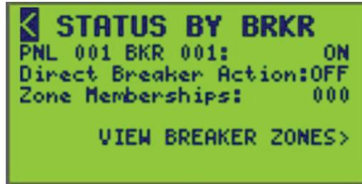
Le panneau, le numéro de disjoncteur, l'état réel du disjoncteur, l'action directe du disjoncteur et le nombre de zones auxquelles le disjoncteur appartient sont affichées. Si le disjoncteur n'était membre d'aucune zone, « 000 » s'affiche comme dans l'écran ci-dessus. Voir le tableau ci-dessous pour la description des options de l'écran STATUS BY SOURCE.
