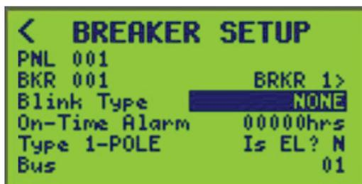
Dans cet écran, le type de clignotement pour le disjoncteur 001 (nommé BKR 1) sur le bus de commande 01 est réglé sur NONE.
