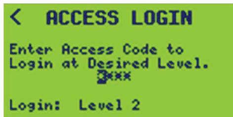
3. Guarde la entrada del código moviendo el cursor a la flecha de salida ACCESS CODES (<) en la parte superior de la pantalla.
