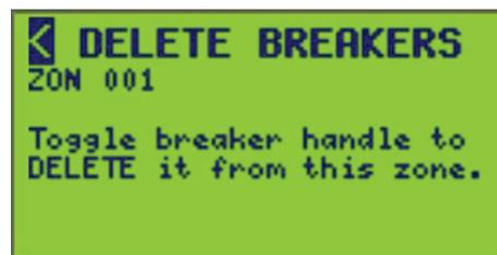
El controlador se coloca en el modo LEARN al entrar en cualquiera de estas pantallas. Todos los interruptores automáticos que cambian de estado mientras se encuentra en la pantalla ADD BREAKERS o DELETE BREAKERS se AGREGA o se ELIMINA del mapa del interruptor automático de la zona.
