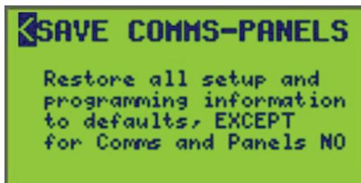
2. Seleccione "YES" (sí) para restaurar parcialmente el controlador a los valores predeterminados de fábrica (excluida la configuración de comunicaciones y de paneles).
