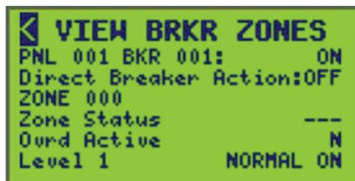
Se muestra el número del interruptor automático, el panel, el estado real y el estado de acción directa del interruptor con el estado de la zona asignada, el estado de anulación y el nivel de prioridad. Consulte Información de zona por datos de fuente de control, página 90 para obtener las descripciones de las opciones de fuente del control.
