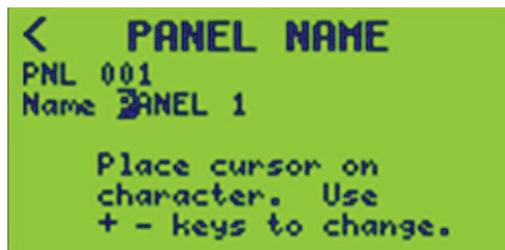
4. Para guardar, presione la tecla "<" y vuelva a la pantalla PANEL SETUP.
