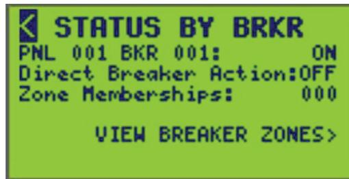
Se muestran el panel, el número de interruptor automático, el estado real del interruptor automático, la acción directa del interruptor y la cantidad de zonas a las que pertenece el interruptor automático. Si el interruptor automático no era miembro de ninguna zona, se muestra "000" como se muestra en la pantalla anterior. Consulte la tabla a continuación para conocer las descripciones de las opciones de la pantalla STATUS BY SOURCE.
