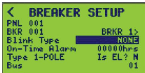
En esta pantalla, el BLINK TYPE para el interruptor automático 001 (denominado BKR 1) en la barra de control 01 está configurado en NONE.
