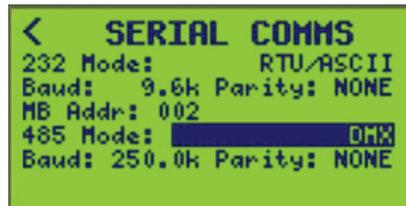
La pantalla del controlador cambiará automáticamente para mostrar los campos de configuración del modo DMX512.
