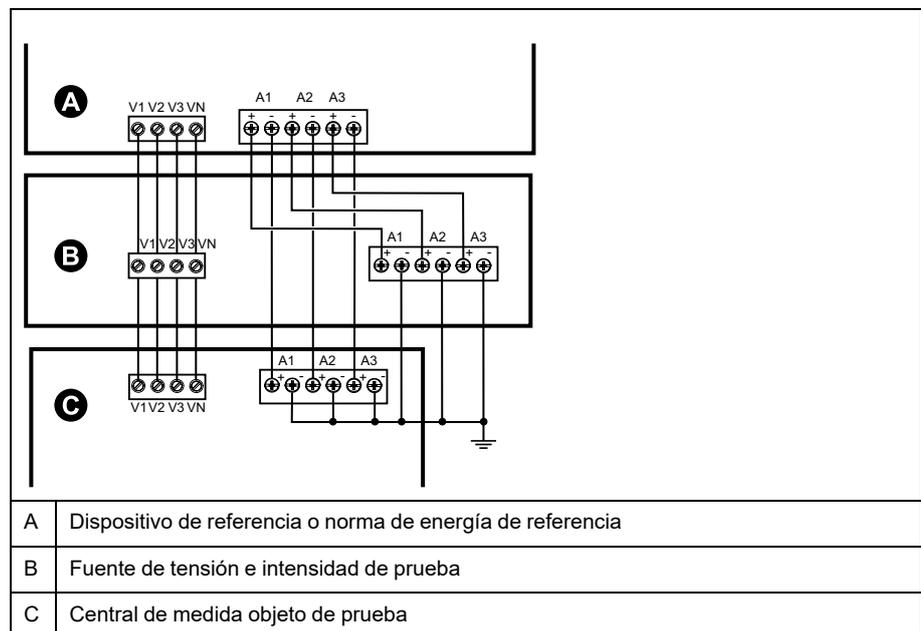
4. Conecte el equipo de control utilizado para contar los impulsos de salida estándar con uno de los siguientes métodos:
