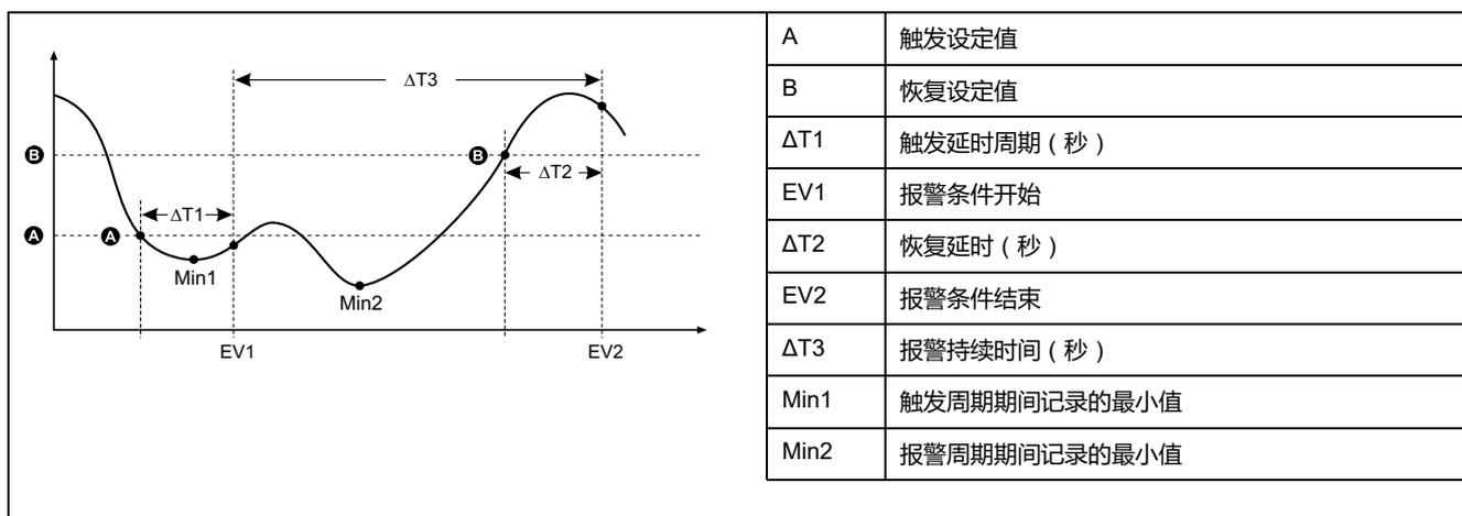
测量仪将记录报警事件开始 (EV1) 和结束 (EV2) 的日期与时间。此外，测量仪还将执行分配给事件的任何任务，例如操作数字输出。测量仪也将记录报警周期之前、之中或之后的最小值 ( Min1、Min2 ) 。
