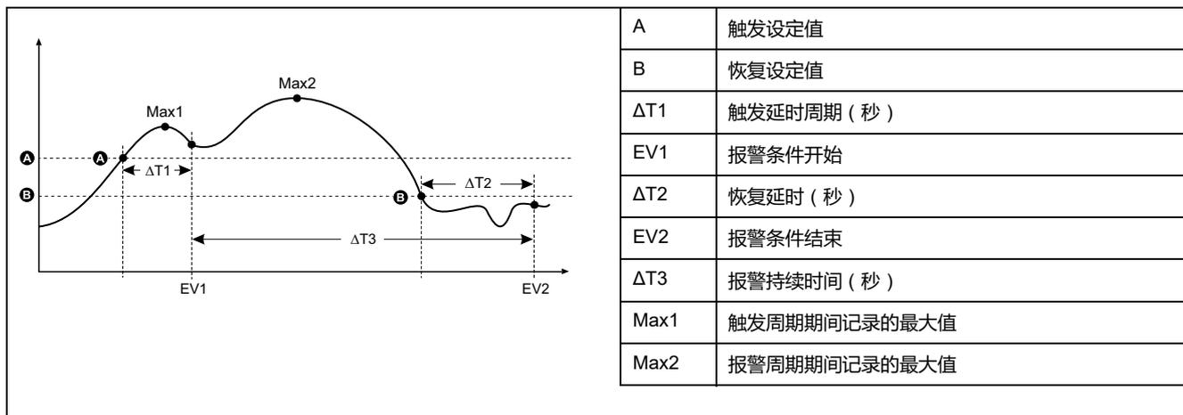
测量仪将记录报警事件开始 (EV1) 和结束 (EV2) 的日期与时间。此外，测量仪还将执行分配给事件的任何任务，例如操作数字输出。测量仪也将记录报警周期之前、之中或之后的最大值 ( Max1、Max2 ) 。
