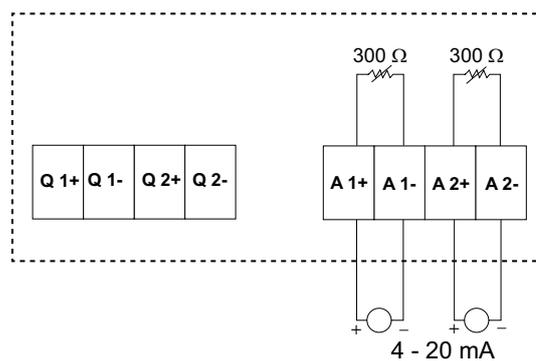
仅可以通过通讯在测量仪上配置以下模拟输入：
