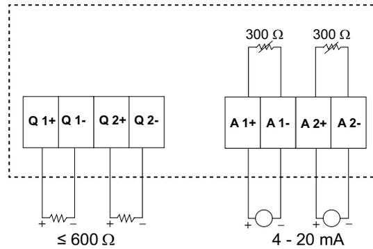
仅可以通过通讯在测量仪上配置以下模拟输出：
