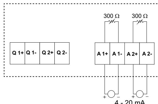
可以在测量仪上配置以下模拟输入：
