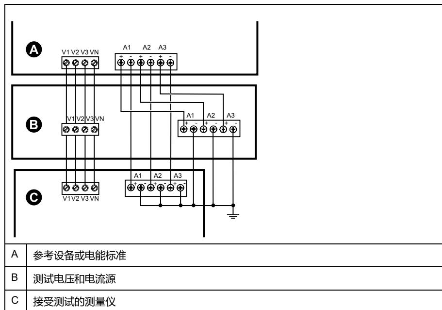
4. 使用以下其中一种方法连接用于为标准输出脉冲计数的控制设备：
