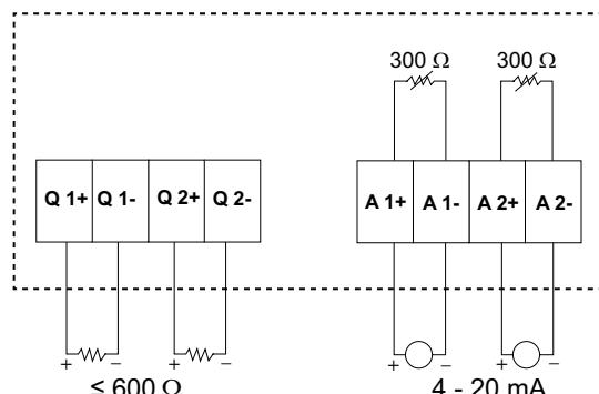
可以在测量仪上配置以下模拟输出：
