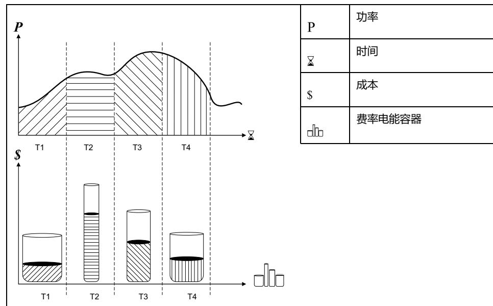
在上述图示中，功率曲线下方的面积等于消耗的电能。
