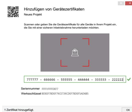
**HINWEIS:** Das Zertifikat besteht aus Seriennummer und Sicherheitsschlüssel FDSK (Factory Default Setup Key). Der FDSK wird nur für die Erstinbetriebnahme verwendet und beim ersten Download durch die ETS ersetzt. Dadurch wird verhindert, dass sich Unbefugte Zugang zur Anlage verschaffen können, auch wenn sie den FDSK kennen.
