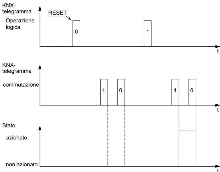
L'impostazione del parametro provoca l'impostazione dell'“oggetto logico” sul valore “0”. Dopo un RESET, l'attuatore non commuta l'uscita finché non viene ricevuto un telegramma “1” sull'“oggetto logico”.
