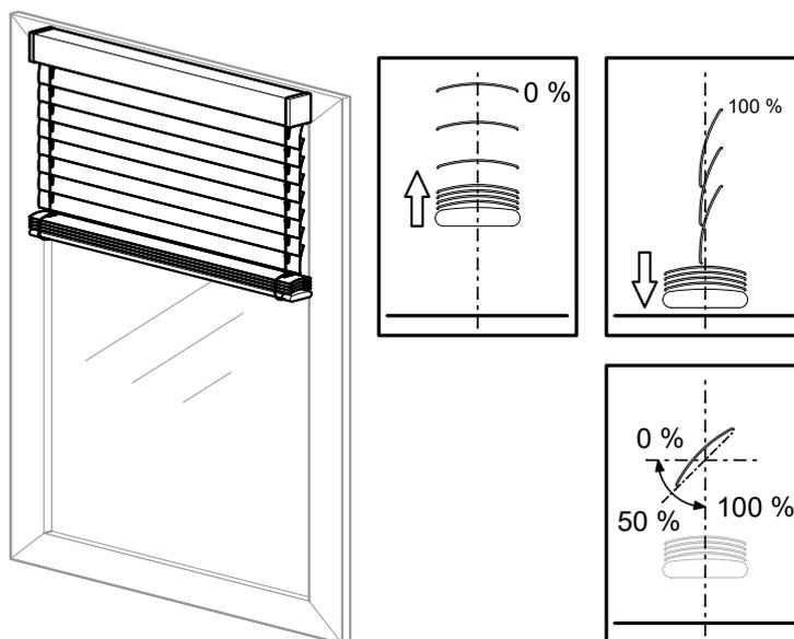
Il parametro **Posizione lamelle dopo movimento in %** consente di definire il comportamento delle lamelle dopo un movimento per il canale. Mediante il parametro **Posizione di lavoro** è possibile impostare l'angolo di apertura che le lamelle devono assumere dopo ogni movimento di discesa.
