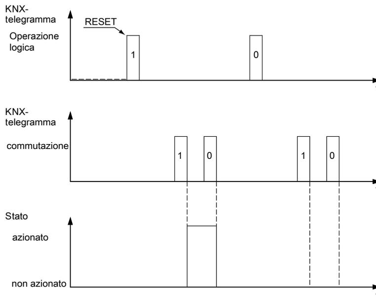
L'oggetto logico è preimpostato sul valore "1" dopo un RESET (ripristino della tensione del bus e download). In questo modo, la commutazione può essere eseguita come di consueto tramite l'oggetto Commutazione. Il blocco di alimentazione non è attivo finché non viene ricevuto un telegramma "0" tramite l'oggetto logico.
