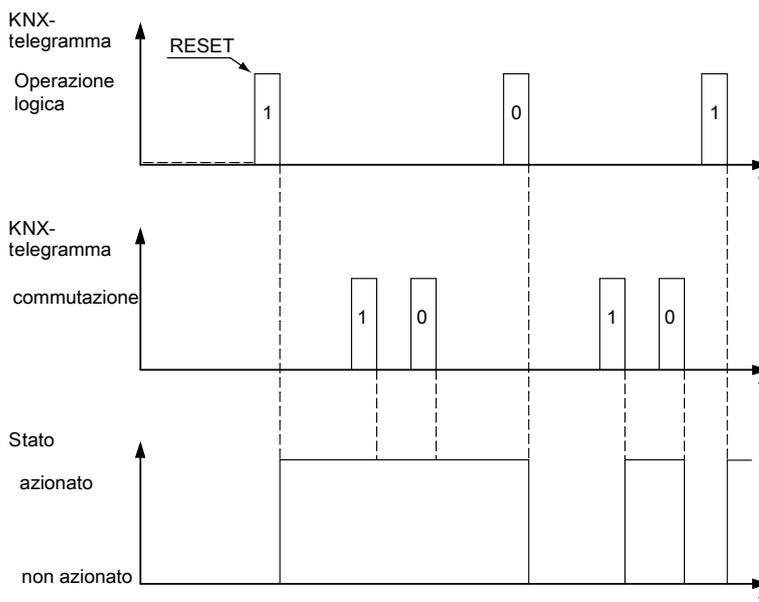
L'oggetto logico è preimpostato sul valore "1" dopo un RESET. L'attuatore attiva immediatamente l'uscita. La funzione logica OR viene resettata solo tramite un telegramma "0" sull'oggetto logico.
