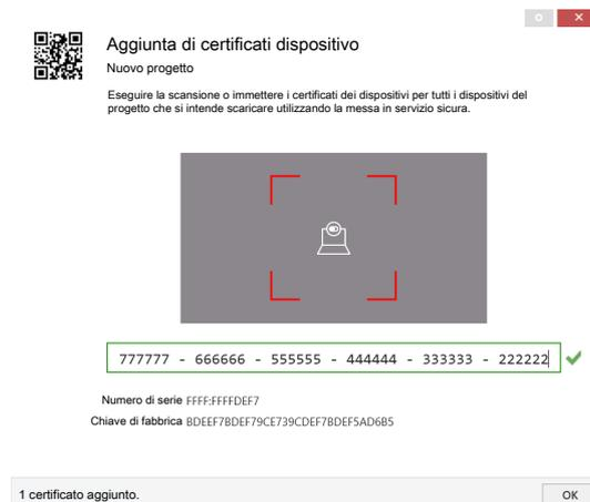
**NOTA:** Il certificato è costituito dal numero di serie e da una chiave di sicurezza FDSK (Factory Default Setup Key). La FDSK viene utilizzata solo per la messa in servizio iniziale ed è sostituita dall'ETS durante il primo download. Ciò impedisce a persone non autorizzate di accedere all'impianto pur conoscendo la FDSK. La FDSK è stampata sull'etichetta del dispositivo sia come codice QR che sotto forma di testo.
