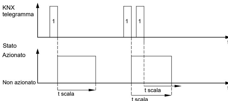
Tuttavia, se la durata della temporizzazione non è riavviabile, il relè si spegne esattamente nel momento in cui scade il tempo.
