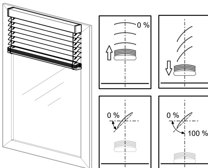
Il parametro **Posizione lamelle dopo movimento in %** consente di definire il comportamento delle lamelle dopo un movimento per il canale.
