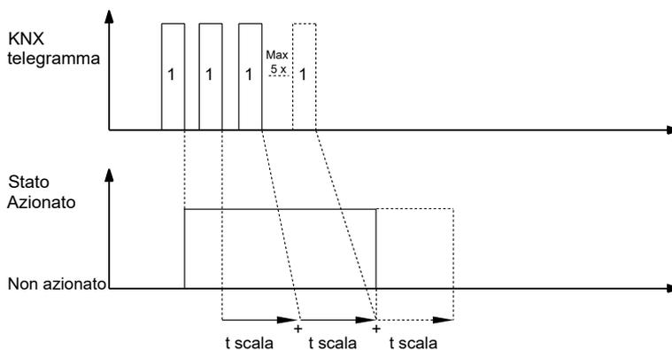
Alla ricezione di uno o più nuovi telegrammi con il valore dell'oggetto "1", la durata della temporizzazione viene aggiunta alla durata della temporizzazione precedente. Il numero di aggiunte può essere impostato. È possibile parametrizzare un massimo di 5 aggiunte alla durata della temporizzazione.
