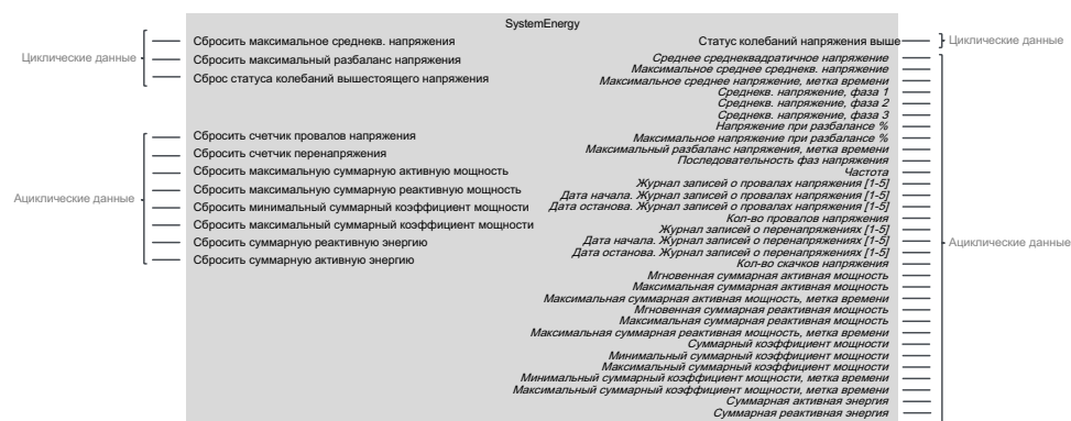
рисунок 32 - Функциональный блок SystemEnergy
