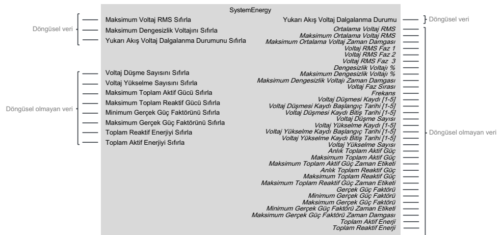
Şekil 32 - SystemEnergy İşlev Bloğu
