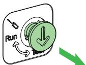
3. Inserte el destornillador y gire el conmutador dieléctrico en el sentido de las agujas del reloj para colocarlo en la posición **Run** después de la prueba dieléctrica.
