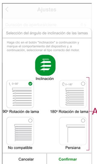
**IMPORTANTE:** Si la persiana se instala con una lama o pantalla que no gira, el proceso de calibración se habrá completado y no es necesario realizar más pasos.
