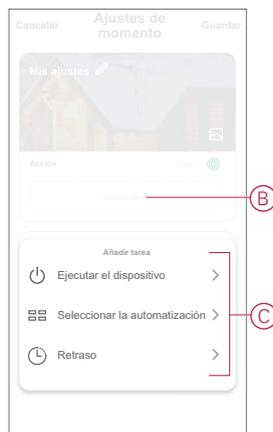
6. Toque **Ejecutar el dispositivo > Detector de movimiento con regulador** para seleccionar una o todas las funciones que desee añadir en el momento y toque **Guardar**:
