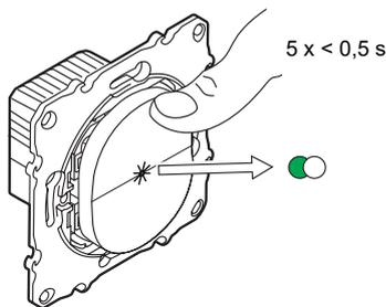
La lumière connectée à l'interrupteur variateur clignote quelques fois. La LED d'état cesse de clignoter en vert sur le commutateur sans fil et l'interrupteur variateur. L'interrupteur variateur peut désormais être contrôlé par le commutateur sans fil.
