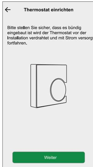
4. Halten Sie den Thermostat-Drehtaster (> 3 s) gedrückt, bis **Jn** am Gerät erscheint.
