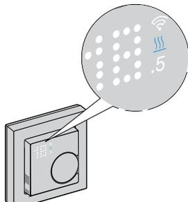
> 5 | Auf der Thermostat-Matrixanzeige leuchtet eine blaue LED dauerhaft, um anzuzeigen, dass der Thermostat kühlt, wenn der Sollwert niedriger ist als die aktuelle Raumtemperatur.<br><b>HINWEIS:</b> Der Kühleingang wurde aktiviert. |
