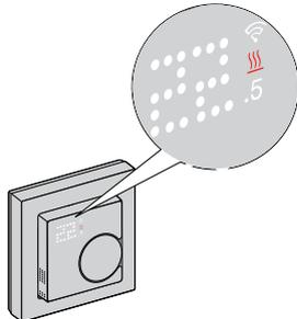
> 5 | Auf der Thermostat-Matrixanzeige leuchtet eine rote LED dauerhaft, um anzuzeigen, dass der Thermostat heizt, wenn der Sollwert höher ist als die aktuelle Raumtemperatur.<br><b>HINWEIS:</b> Der Heizeingang wurde aktiviert.      |
