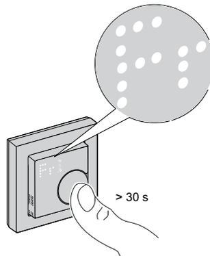
**HINWEIS:** Wenn der Drehtaster losgelassen wird, blinkt „Fr“ auf der Punktmatrix-Anzeige, der Thermostat wird auf die Werkeinstellungen zurückgesetzt und nach 5 Sekunden kehrt er zu Voreinstellung, Seite 8 zurück.
