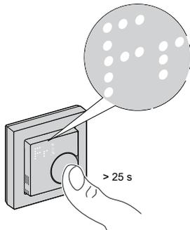
> 25 s | Auf der Thermostat-Matrixanzeige wird eine LED „Fr“ dauerhaft angezeigt, bis der Benutzer den Drehtaster loslässt, dann blinkt „Fr“. Weitere Informationen finden Sie im Abschnitt Gerät zurücksetzen, Seite 50. |
