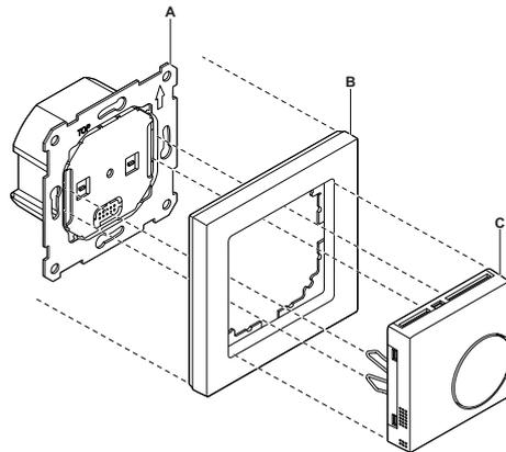
**HINWEIS:** Der Raumtemperurregler-Einsatz 2 A ist nicht für den direkten Anschluss einer Elektroheizung geeignet.
