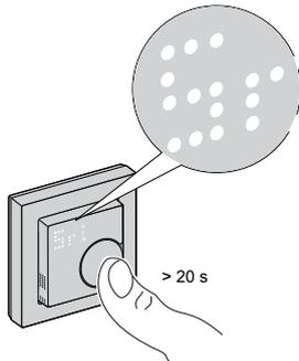
> 20 s | Auf der Thermostat-Matrixanzeige wird eine LED „Sr“ dauerhaft angezeigt, bis der Benutzer den Drehtaster loslässt, dann blinkt „Sr“. Weitere Informationen finden Sie im Abschnitt Gerät zurücksetzen, Seite 50. |
