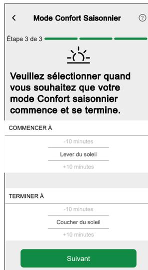
**NOTE:** Vous pouvez démarrer et arrêter le mode Confort saisonnier quelque temps avant ou après le lever/coucher du soleil. Cela améliore la précision des réglages lorsque les capteurs de luminosité ne sont pas installés et que votre bâtiment est ombragé par un autre bâtiment ou une montagne qui empêche la lumière du soleil d'atteindre votre emplacement.
