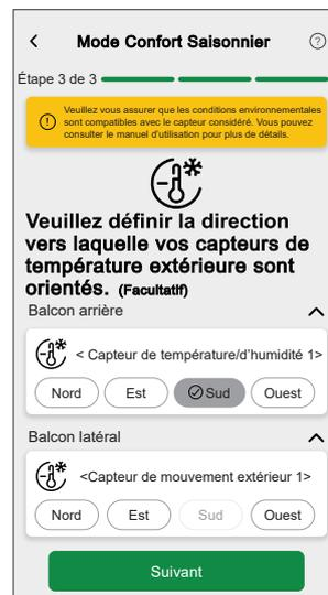
**NOTE:** Vous pouvez appuyer sur **Non** si les capteurs de température extérieure ne sont pas installés.
