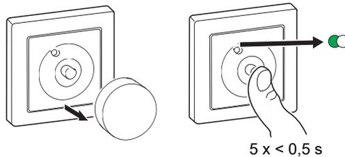
La lumière connectée au variateur rotatif clignote quelques fois. La LED d'état cesse de clignoter en vert sur le commutateur sans fil et le variateur rotatif. Le variateur rotatif peut désormais être commandé par le commutateur sans fil.
