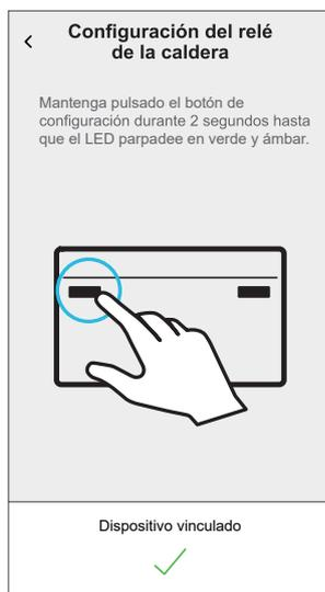
**SUGERENCIA:** Si el dispositivo no se conecta, el LED se ilumina en rojo.
