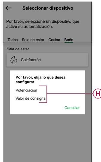
9. Toque **Valor de consigna**, ajuste la temperatura requerida con la barra deslizable vertical (I) y, a continuación, toque **Establecer**.
