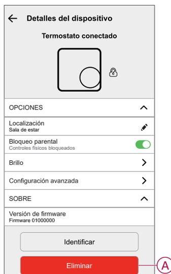
3. Lea el mensaje de confirmación y toque **Ok** para eliminar el termostato del sistema Wiser.
