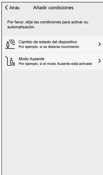
7. Pulse el dispositivo para abrir la pantalla **Control de dispositivos** y configurar su estado para activar la automatización (por ejemplo, se detecta movimiento). A continuación, pulse **Configurar**.
