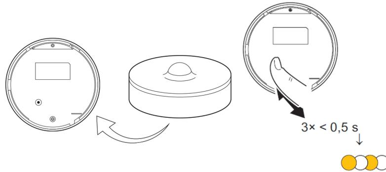
Attendez quelques secondes que la LED passe au vert et l'application confirme que l'appareil est appairé.
