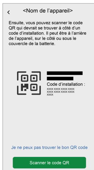
**NOTE:** Si le variateur ne dispose pas de code QR ou d'**adresse MAC** et de **code d'installation**, vous pouvez l'appairer manuellement en appuyant sur **Je ne peux pas trouver le bon QR code**. Cependant, il est fortement recommandé d'utiliser un code QR ou l'**adresse MAC** et le **code d'installation** pour l'appairage.
