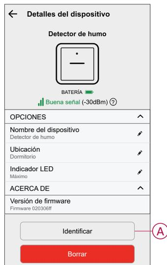
**NOTA:** El LED del dispositivo puede tardar hasta 60 minutos en parpadear e identificarse, dependiendo del momento en el que el detector de humo inalámbrico envía una señal al Hub dentro de su intervalo regular.
