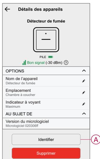
**NOTE:** Le voyant de l'appareil peut mettre jusqu'à 60 minutes à clignoter et à identifier, selon le moment où le détecteur de fumée envoie un signal à la passerelle dans son intervalle régulier.
